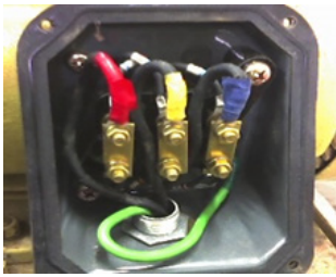
Motor con regleta o borneras
