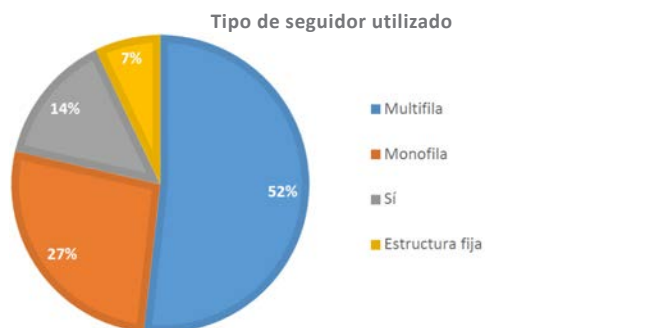
Figura 40. Programa RenovAr. Tipo de seguidor utilizado en los proyectos
