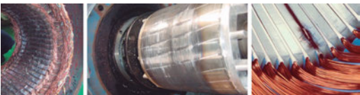
Figura 5. Daños típicos en núcleos laminados.
