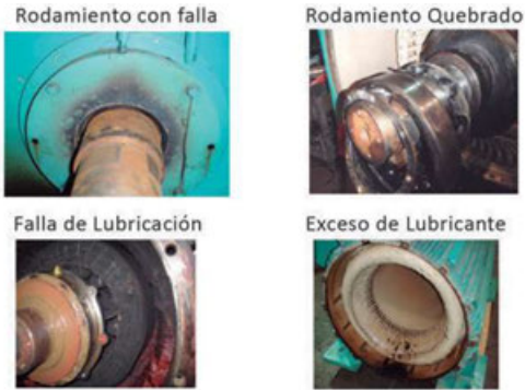
Figura 5. Fallas mecánicas en aerogeneradores.
