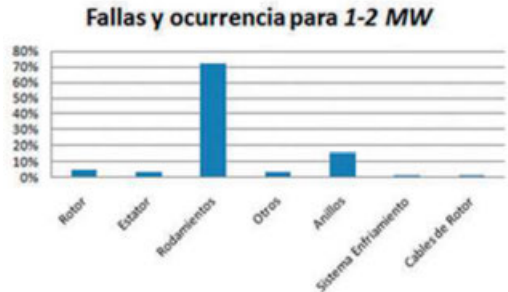
Figura 3. Fallas más comunes en aerogeneradores 1 a 2 MW.
